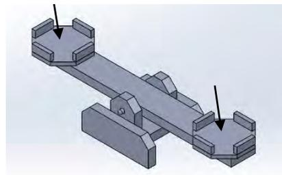
6. **Cómo calibrarlo:** estas balanzas gigantes no están calibradas y solían ser para averiguar el peso y el equilibrio. Si quieres utilizarlo para tomar medidas y peso exacto; se pueden calibrar mediante la colocación de madera en cada uno de los cubos hasta que se queden bien alineados o encima de la viga de equilibrio, en un lado y otro. Al mismo tiempo, los alumnos podrían aprender a calibrar un objeto para obtener un resultado más concreto y fiable.
