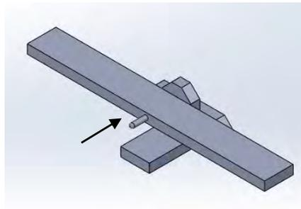
5. Colocar los soportes de cubos en la posición indicada en la imagen y atornillarlos en la dirección que se muestra en la imagen.
