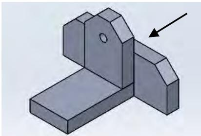
4. Colocar la base al otro lado de la viga; tal y como se muestra en la imagen y repetir el paso 2.
